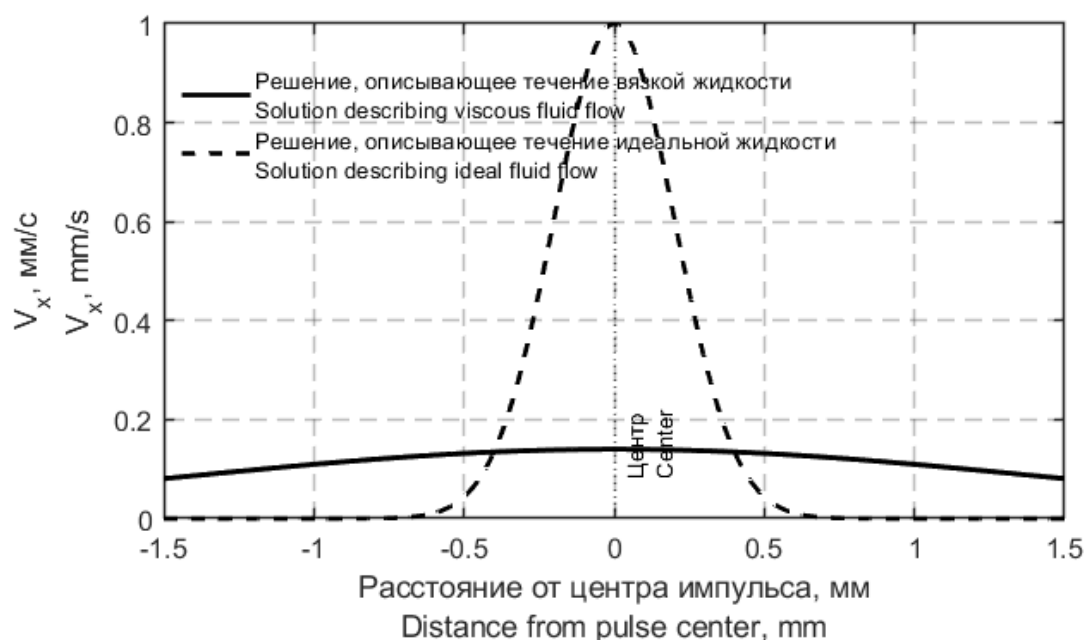
Рис. 4. Сравнение решений для вязкой и идеальной жидкости: гауссов импульс при t = 1 с. Начальная полуширина \sigma_0 = 0.2 мм, амплитуда 1 мм/с
