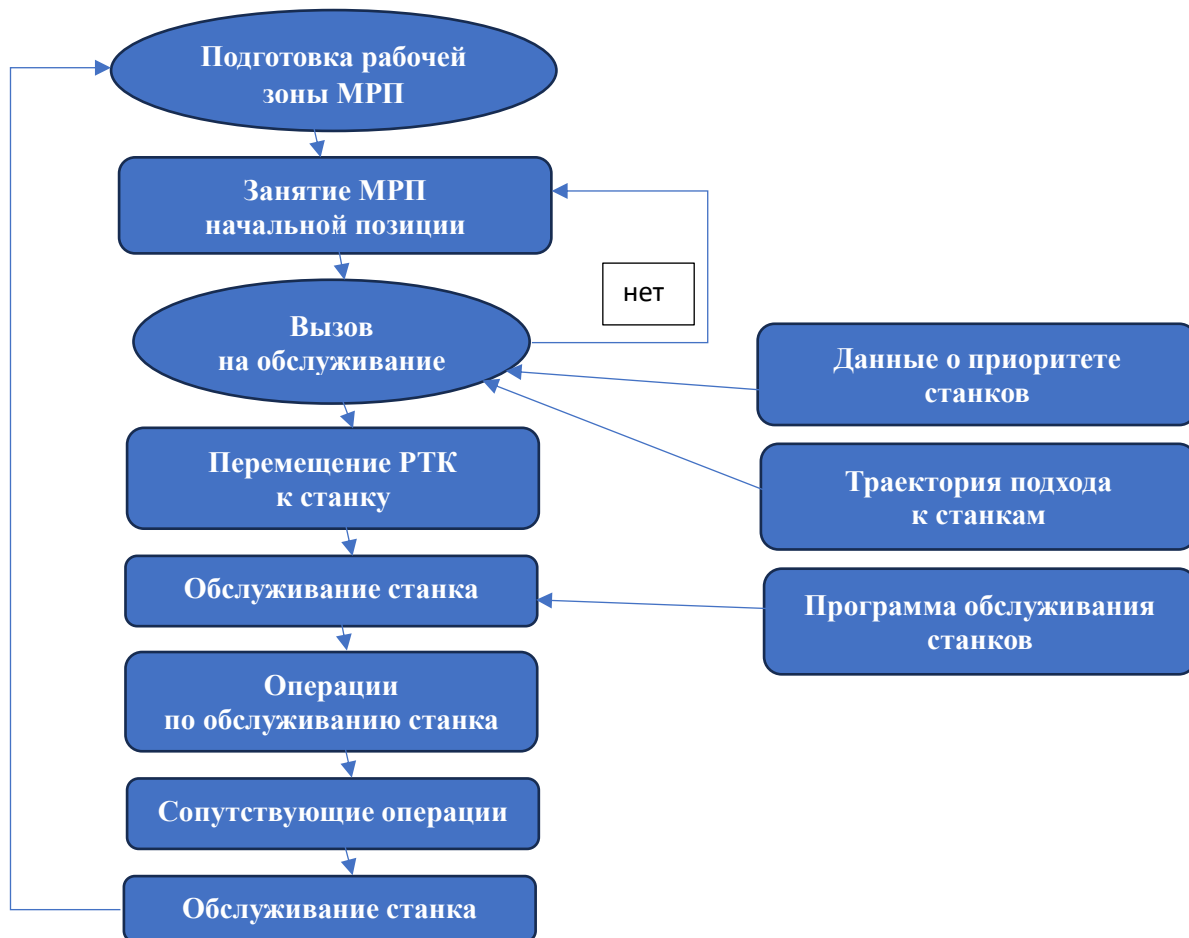
Рис. 3. Алгоритм обслуживания станков с ЧПУ
