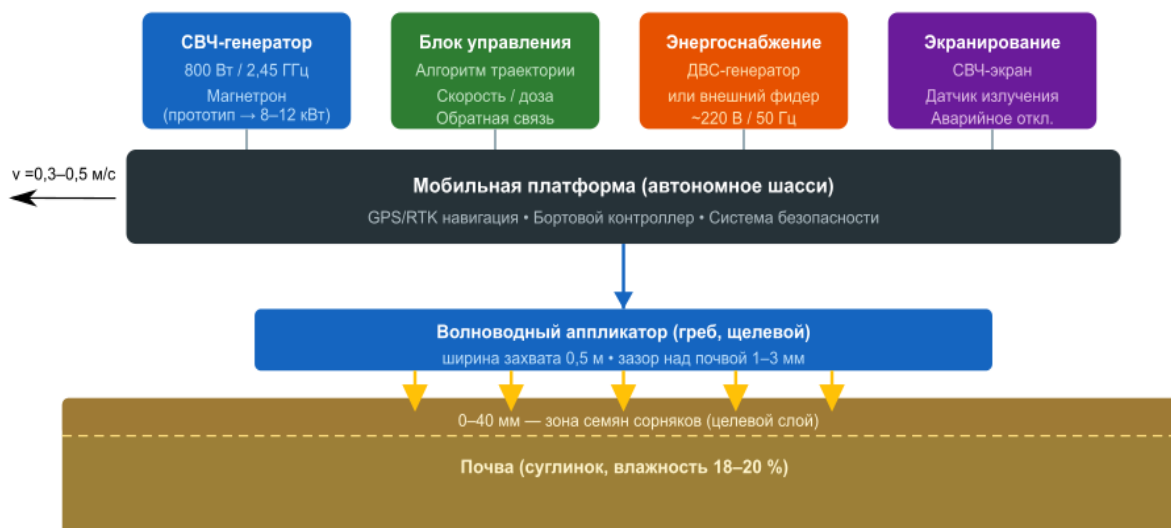
Рис. 2. Концептуальная схема роботизированного СВЧ-аппликатора для предпосевной обработки почвы [8]
