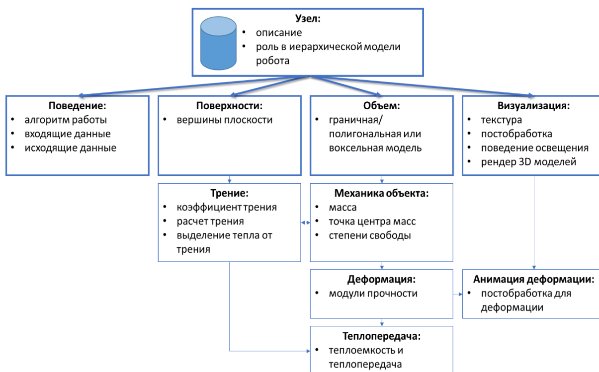
Рис. 2. Пример структуры модальностей при моделировании отдельного узла робота
