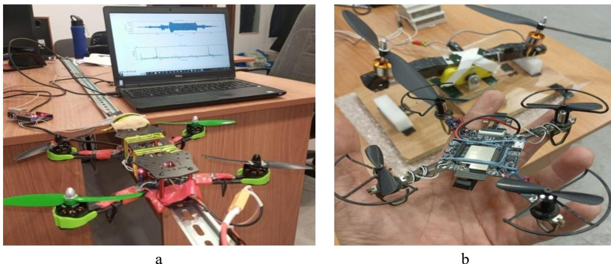
**Рис. 7.** Экспериментальные установки с датчиком, расположенным вне платформы (a), и с датчиком, установленным непосредственно на платформе (b)
