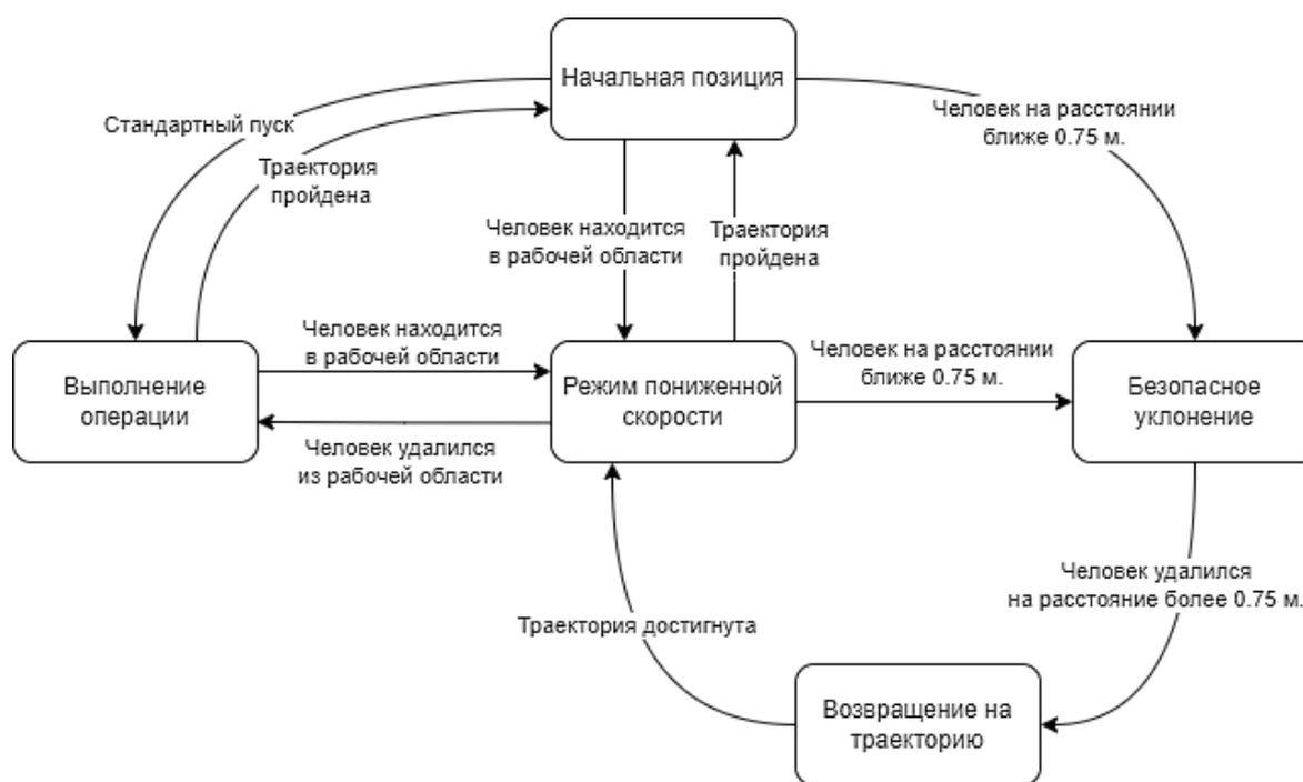
**Рис. 7.** Конечный автомат робототехнической ячейки для контроля столкновений с человеком
