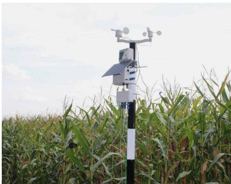
*Рис. 4. Полевая метеостанция для ИИС «Умное поле»*
